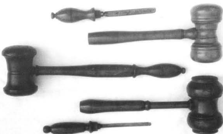
Pl.39 Maillets à sucre : 3 maillets dont deux sont ouverts (les manches en bois se dévissent).
