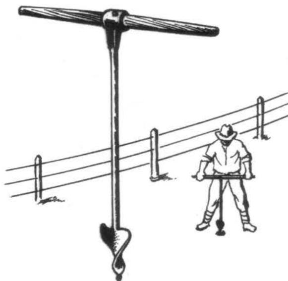
Fig.7 Une tarière pour la pose des piquets de clôture.
