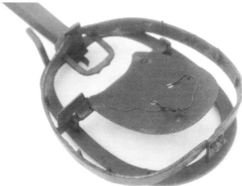
Piège à palette : système de déclenchement.
