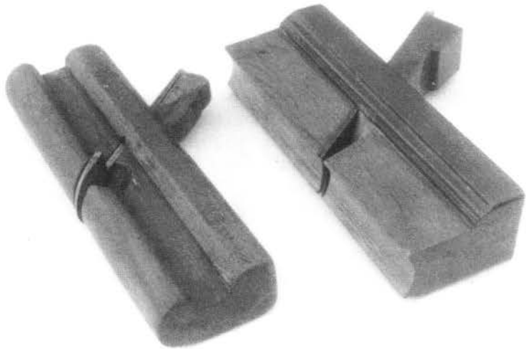
Paire de rabots dits "gueule de loup", destinés à assurer une fermeture étanche des fenêtres.
