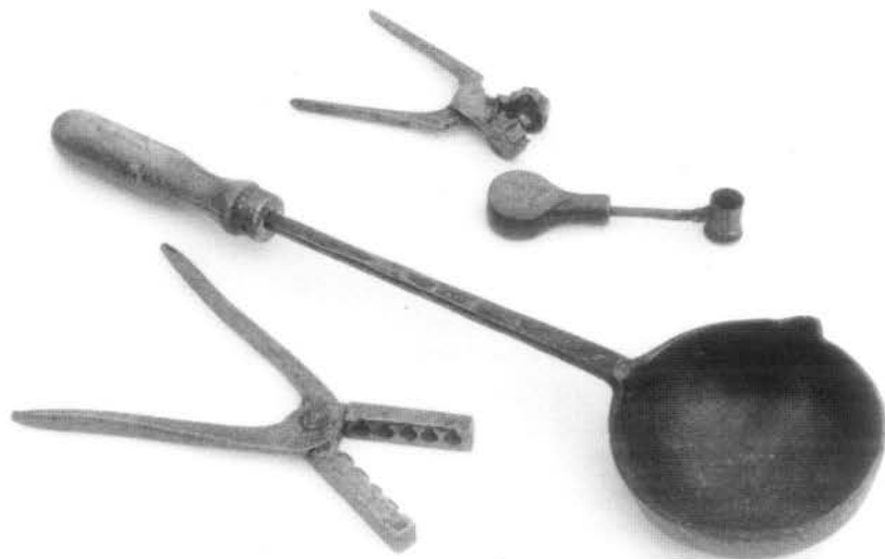
Louche de forge pour fondre le plomb des balles, doseur à poudre et moules à balles.
