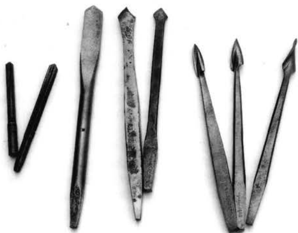
Pl. 42. Mèches à pierre et à briques (langue d'aspic), avec, à gauche deux mèches de tamponnoir.
