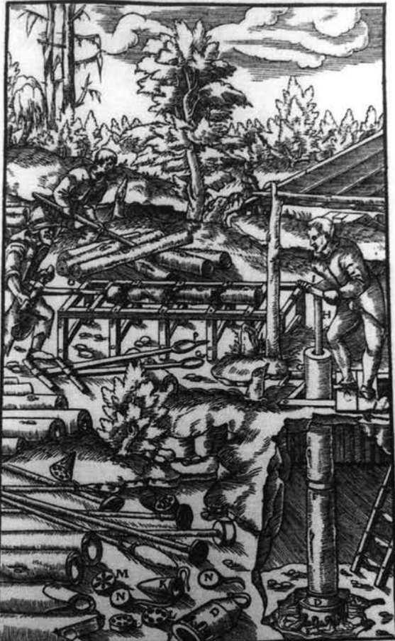
A: Puitsard B: Tuyaux C: Planches D: Tronc d'arbre E: Trou dans le tronc F: Boîte à clapet G: Tuyau d'évacuation H: Tige de piston I: Saignée K: Chaussure L: Disque avec ouvertures rondes M: Disque avec ouvertures ovales N: Clapet O: Homme perçant les trous P: Tarière à mèche Q: Grosse tarière
