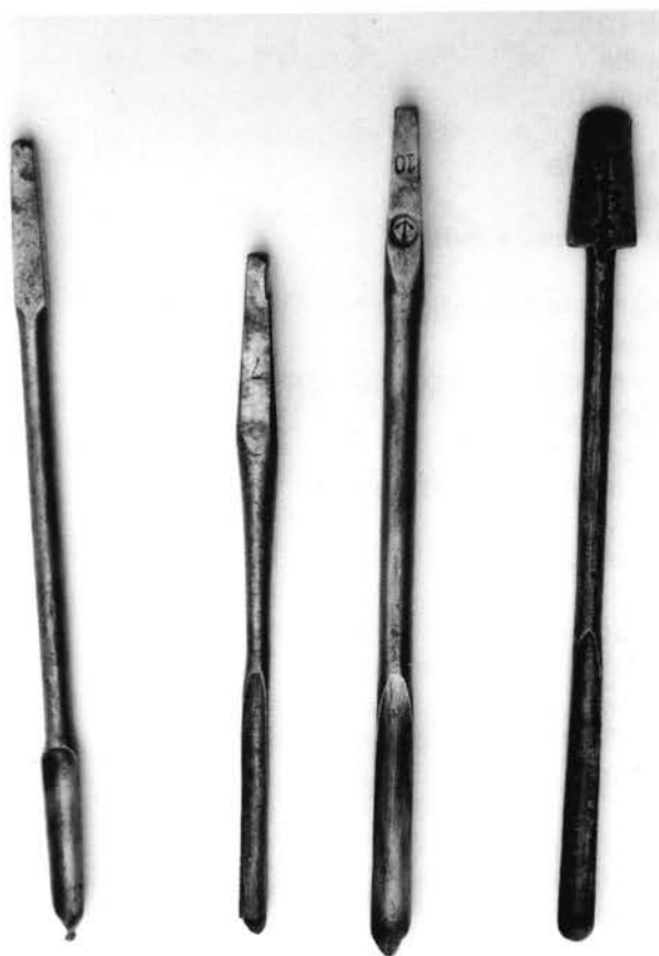
Pl. 43. Mèche à cuillère (à droite), mèches à ferrer (au centre) et cuillère avec amorce de vis (à gauche).
