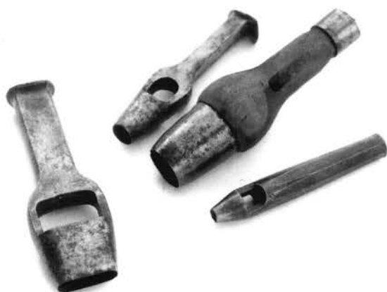
Pl. 13. Un emporte-pièce à enchapure (à gauche) et 3 ordinaires à découpes rondes.
