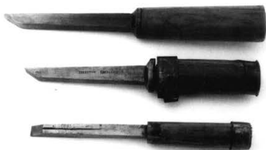
Pl. 1. Trois bédanes, celui du bas est fait d'un fer de bouvet à rainurer.
