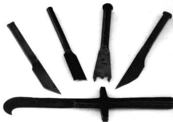
Pl. 2. Cinq bédanes à fiche utilisées pour la mortaise étroite où venait se loger la fiche des gonds de portes (ou de fenêtres).
