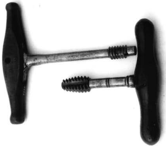
Pl. 70. Tarauds métalliques, à tige creuse et à mandrin.
