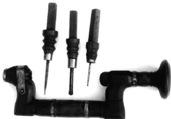
Pl. 33. Vilebrequin en bois avec jeu mèches interchangeable (mèches à pierre en l'occurrence).
