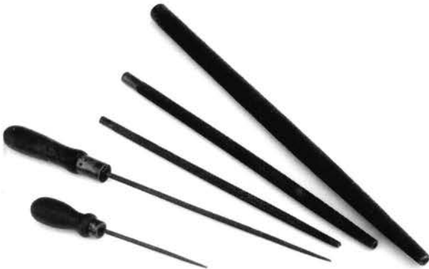
Pl. 57. Quatre limes "queue-de-rat" gigognes (emboîtables) et une petite lime ordinaire.
