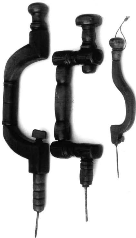
Pl. 35. Trois vilebrequins en bois : à vis dessus (à gauche), dessous (au milieu) et de côté (à droite).
