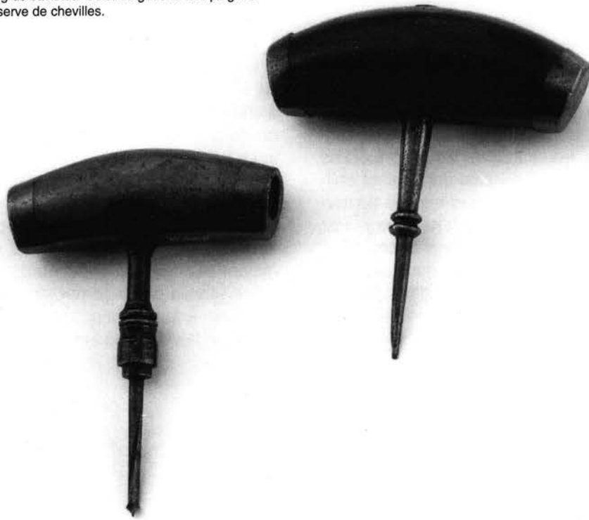
Pl. 9. Deux coups de poing de cavistes. Celui de gauche a la poignée creuse pour une petite réserve de chevilles.
