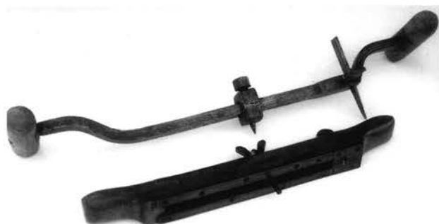
Pl. 14. "Grives" à vacherins (dessus) et à tinettes (dessous)! La seconde, en bois, est d'origine anglaise et servait à découper les supports de cuvettes de toilette dans les anciens meubles lavabos.
