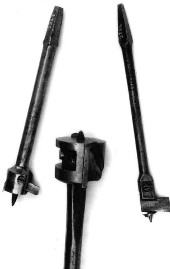
Pl. 48. Deux mèches extensibles et mèche tambour (type Forstner).
