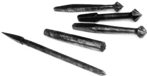
Pl. 50. Trois fraises à pierre (et métal), une fraise-trépan et une mèche à pierre.
