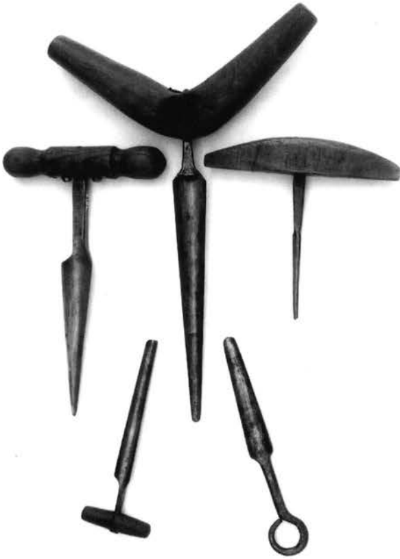
Pl. 65. Trois petits alésoirs coniques et deux sondes à fromage (en bas).
