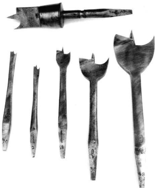
Pl. 47. Cinq mèches à centrer et mèche de tonnelier (pour défoncer les barriques, le talon de la mèche faisait office de bouchon).
