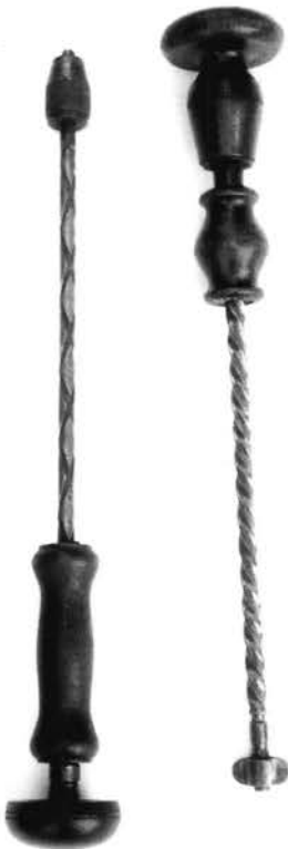
Pl. 40. Drille à double spirale ou à spirales croisées (à gauche), par opposition à une drille à vis sans fin ordinaire.
