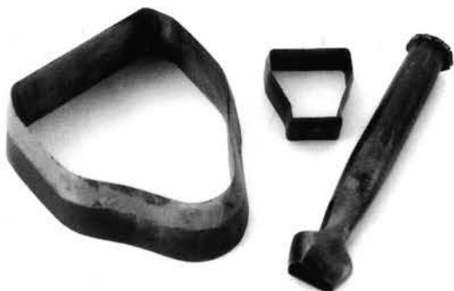
Pl. 17. Deux emporte-pièces de forme (à droite), et pour découper des cartouchières (à gauche).
