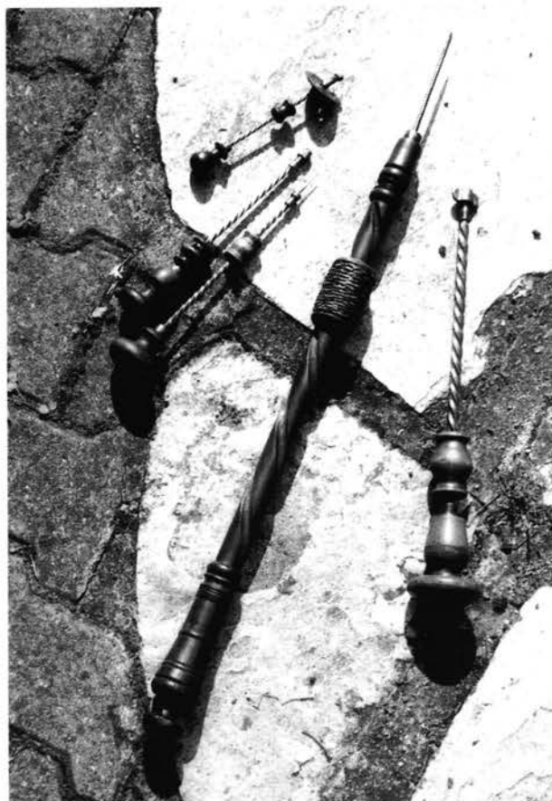
Pl. 26. Drilles à vis sans fin (de menuisier et de marqueteur). Celle du milieu, la plus grande, est entièrement en bois.
