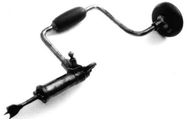
Pl. 38. Un des premiers vilebrequins en fer à système permettant de revenir à vide si besoin est (lors de forage dans les angles).
