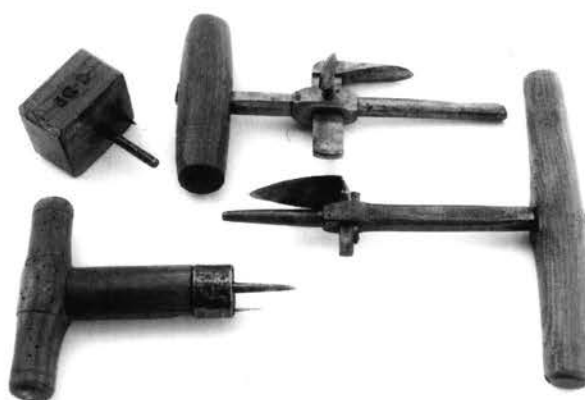
Pl. 12. Couteaux à rondelles : à gauche, 2 fixes et à droite, 2 réglables
