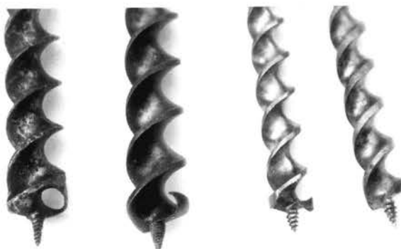
Pl. 45. Quatre mèches hélicoïdales (Cook / Jennings) à têtes différentes.
