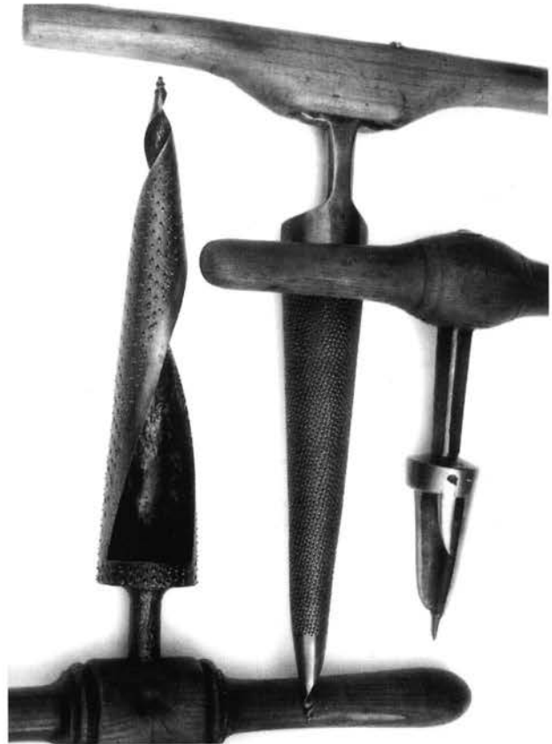
Pl. 66. Trois bondonniers de tonneliers. Celle de droite est un losset.
