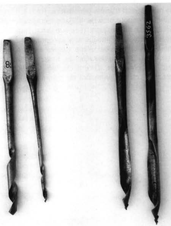
Pl. 44. Mèches à poche, façon Styrie (à droite) et mèches tordues (à gauche).
