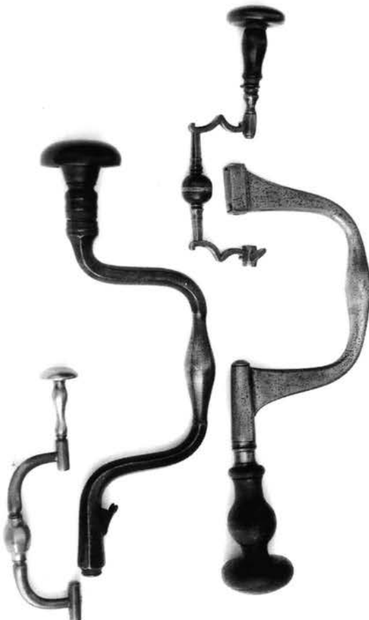
Pl. 36. Quatre vilebrequins en fer simples. Le plus grand avec poignée en haut est équipé d'un système à cliquet pour la mèche (modèle anglais)
