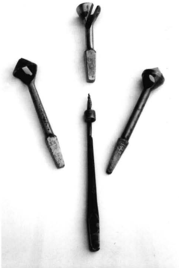
Pl. 49. Deux fraises à bois coniques, une fraise en entonnoir (pour bout des goujons) et une mèche à butée de profondeur.
