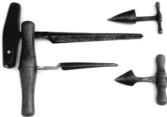
Pl. 61. Deux alésoirs coniques et deux alésoirs courts triangulaires dits "queue-de-cochon", de tonneliers.
