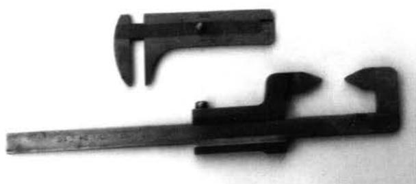
Pl. 21. Autre calibre de mécanicien et mesure à boutons.
