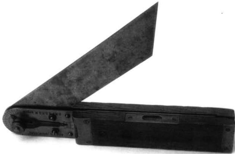
Pl. 37. Instrument de mesures d'angles combiné à plusieurs fonctions.
