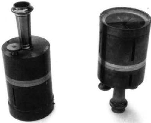
Pl. 35. 2 équerres de géomètre à boussole incorporée dites graphomètres.
