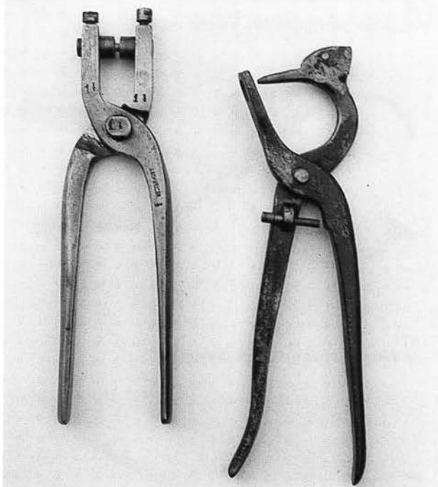
Pl. 89. Pinces de cordonnier à poser (à g.) et ôter les œillets (à dr.).
