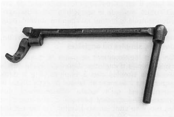
Pl. 34. Clé pour intervenir sur un boulon logé dans un tube ou un tuyau.
