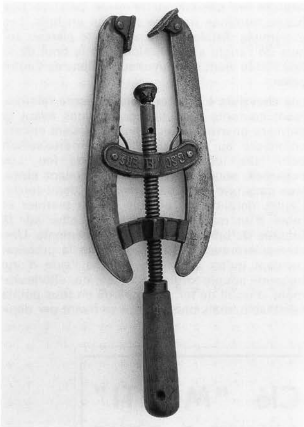
Pl. 45. Serre-joints à 3 points pour collages d'angles.
