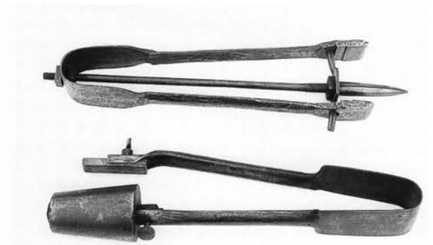
Pl. 84. Pincés de verrier: à façonner les goulots, en haut, à lisser les flancs de bouteilles, en bas.
