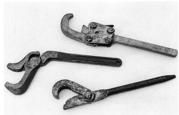
Pl. 39. Pincettes à tuyaux simple, en bas, à double articulation au milieu, et à mécanisme en haut.
