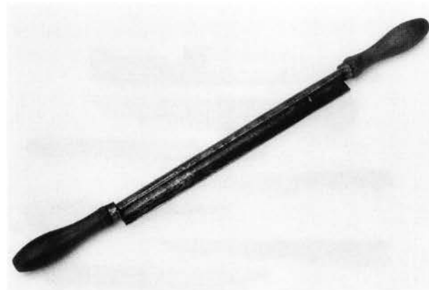
Pl. 55. Curieux couteau à deux mains d'apiculteur, sorte de gouttière dont les deux bords sont tranchants.
