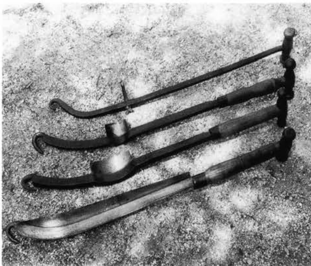
Pl. 63. Planes de sabotiers: plane proprement dite, talonnière et effeuillard.
