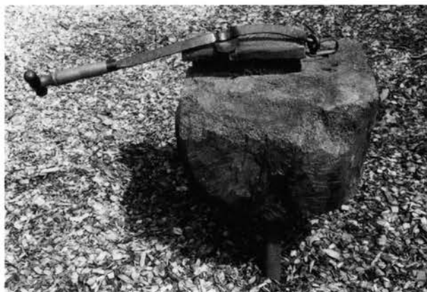
Pl. 64. Le chevalet à boucle du sabotier et du fabricant de bois de socques.
