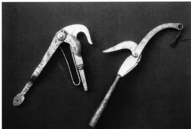
Pl. 44: Deux échenilloirs: longuement emmanchés, ce sont des couteaux articulés, actionnés par une cordelette.
