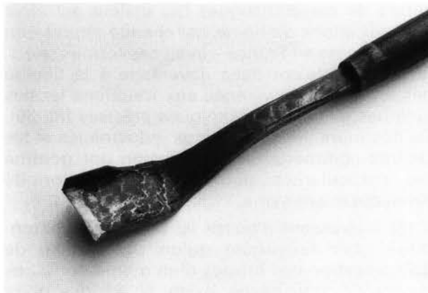
Pl. 45. Couteau-gouge pour lever et découper en lanières la partie tendre des écorces d'épicéa, soit pour façonner les «sangles» à vacherins.
