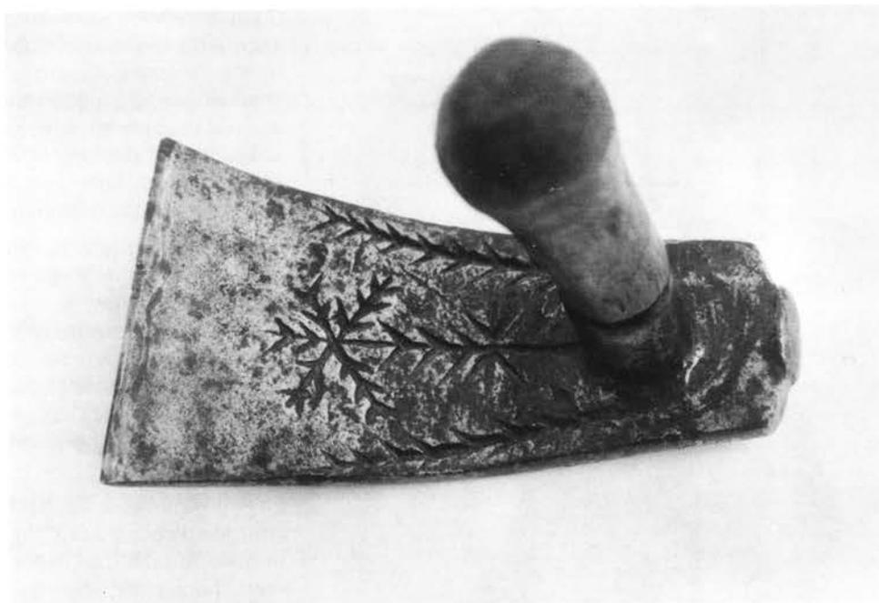
vail pouvait aussi être exécuté avec la hache creuse. La seconde fonction du paroir était de façonner l'extrémité des douves, une fois la barrique achevée, afin de les munir de ce champfrein légèrement creux sur la partie interne du bord.
