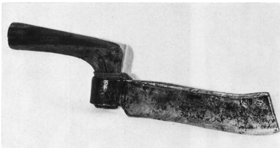
Fig. 13 Fer à tavillons (longueur de la lame 28 cm), collection Musée du bois de l'Arboretum.
