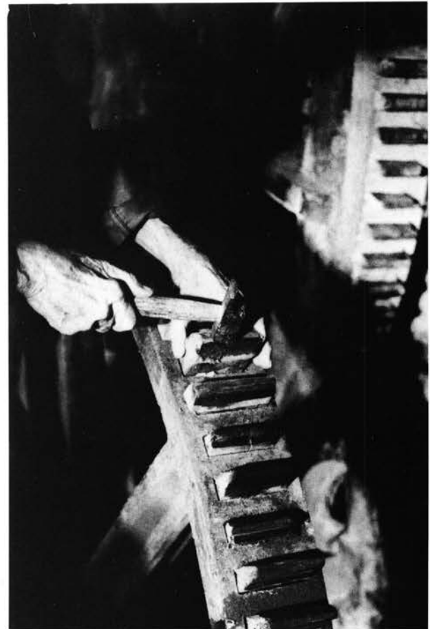
Changement d'une «marmelle» (dent d'engrenage) en bois. Elles sont fabriquées par le scieur qui utilise à cet effet un bois dur, en général du poirier ou éventuellement du frêne.
