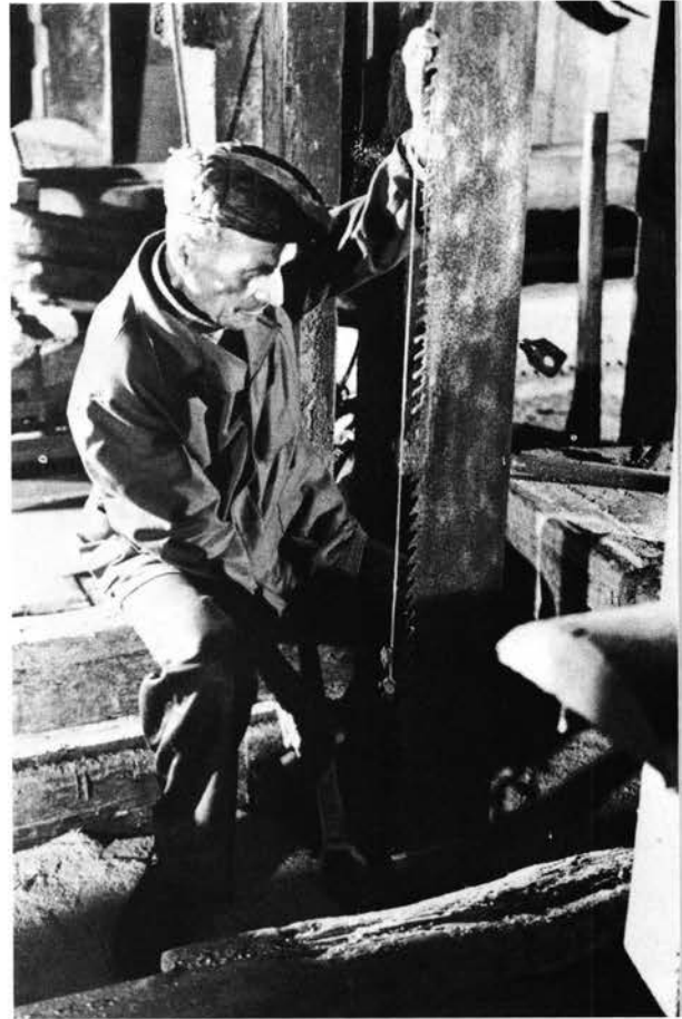
Ajustage de la lame qui doit être légèrement décalée par rapport à la verticale pour que toutes les dents travaillent et pour permettre l'avancement du chariot.
