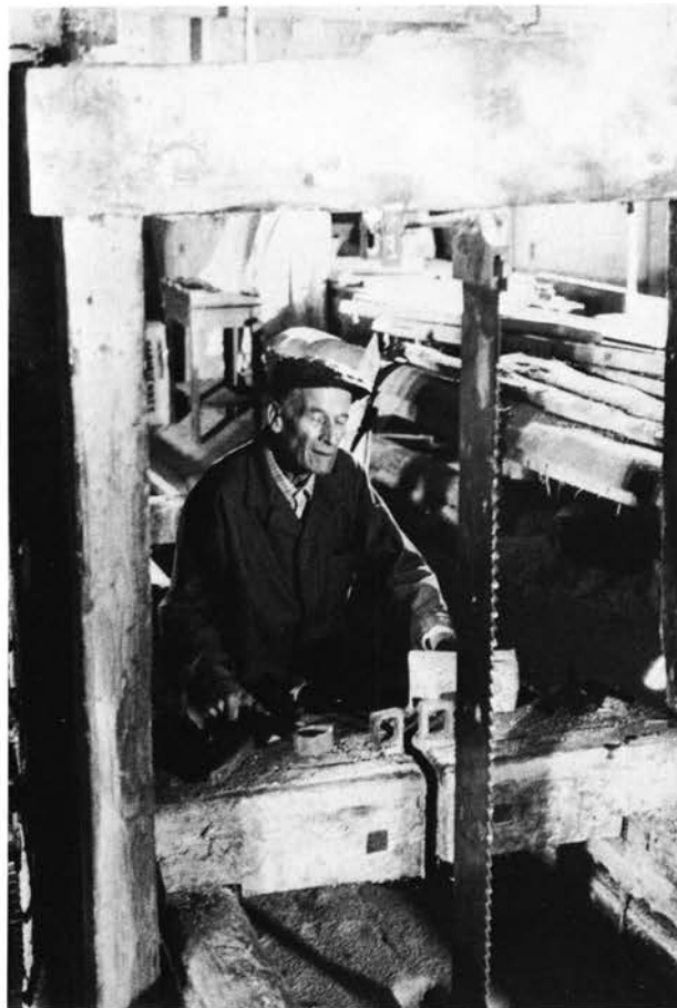
Alignage de la lame «à l'œil» sur un trait de référence tracé contre le mur du bâtiment.
