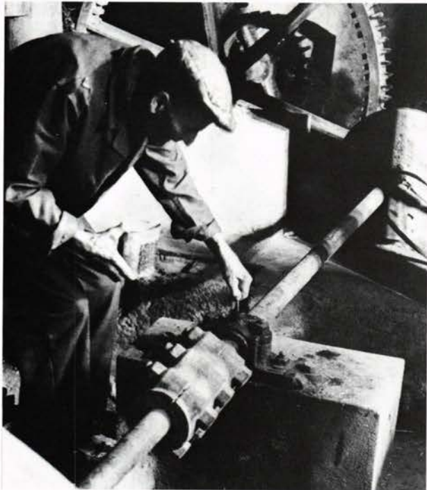
Graissage des paliers de la «mécanique» (transmissions).
