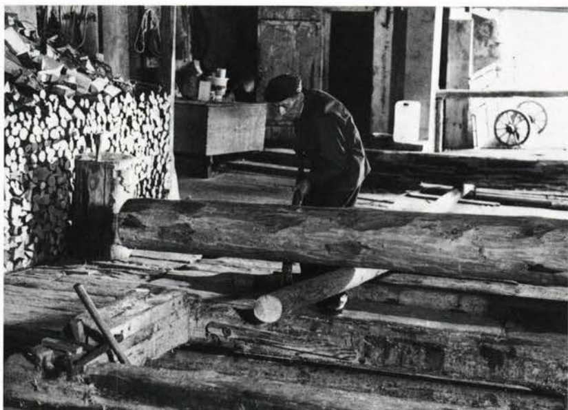
Mise en place du billon sur le chariot avec l'aide du «serpi».
