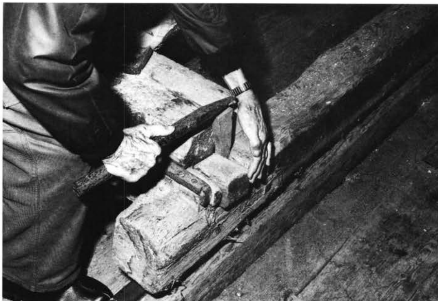
Mise en place d'une cale de référence contre la partie coulissante du chariot.
