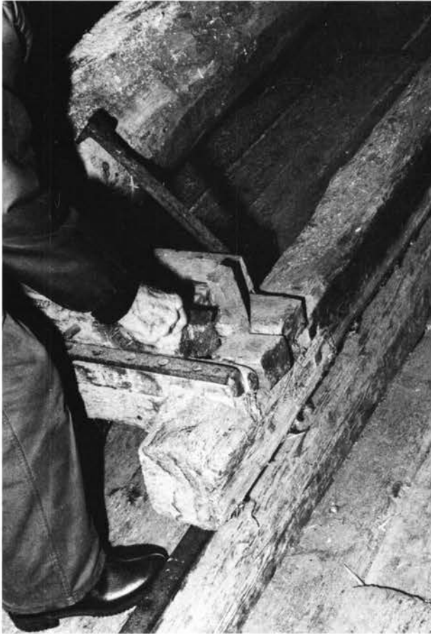
L'épaisseur désirée est obtenue avec un «échantillon» (jauge en bois) glissée entre la partie coulissante et la cale de référence.
