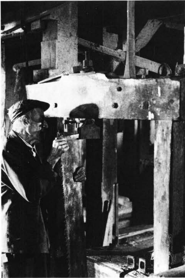
Mise en place de la lame de scie dans les «chapes» (fixations) de la scie à cadre.
