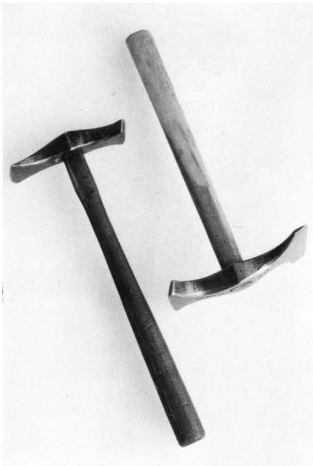
Pl. 13 Marteau à rentrer (à gauche) et marteau à border (à droite).
