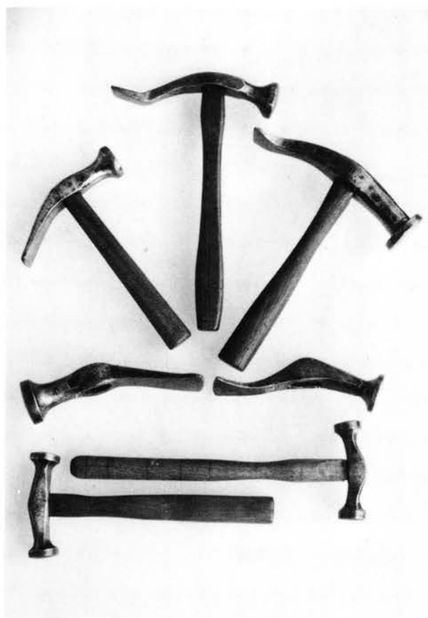
Pl. 38 Marteaux de cordonnier. Les deux du bas sont des marteaux à clouer.
