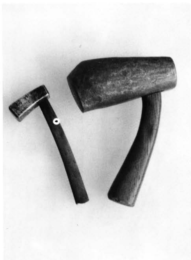
Pl. 15 Deux marteaux de tailleurs de limes. Le petit ne pèse que 270 grammes et le gros 4 kilos et demi!
