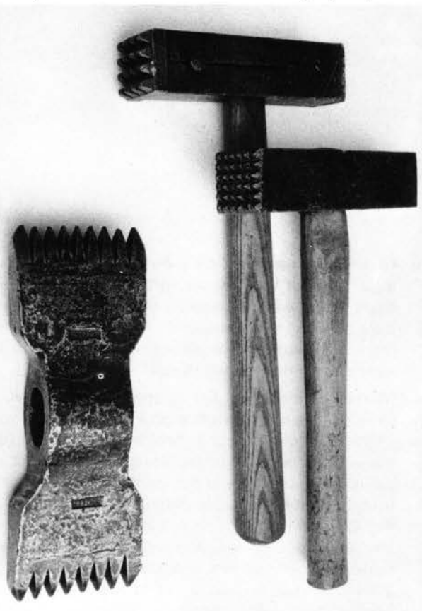
Pl. 20 Rustique et bouchardes (celle de dessous est à plaquette).
