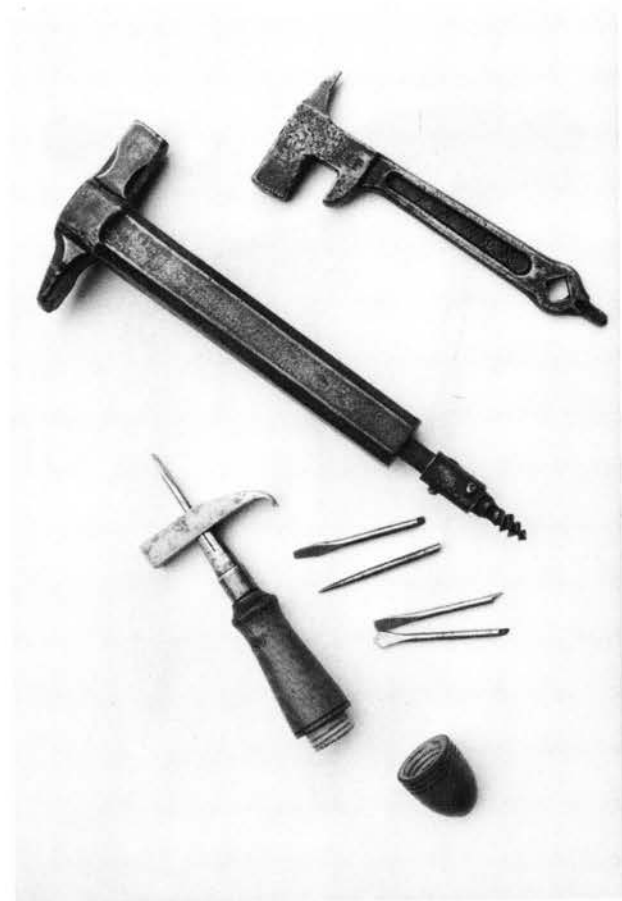
Pl. 42 Outils combinés. En haut marteau-clé à mouchettes de maréchal-ferrant (modèle d'armée suisse).
