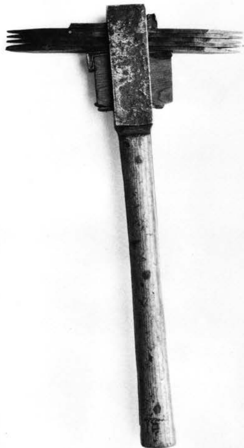
Pl. 19 Peigne de tailleur de pierre. C'est l'outil représenté sur la planche précédente.
