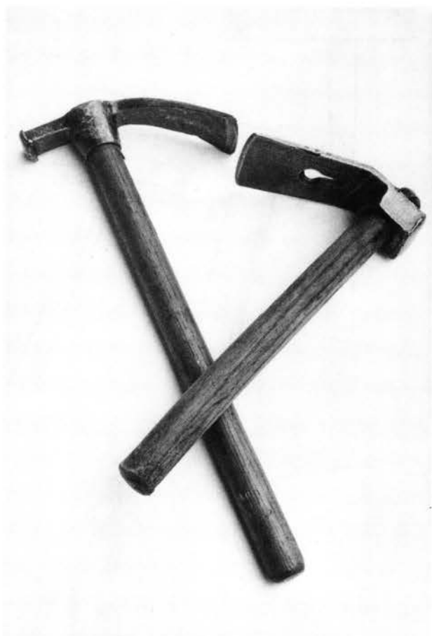
Pl. 30 Marteaux-herminettes ou herminettes-marteaux? C'est l'insidieux glissement d'un outil à l'autre.
