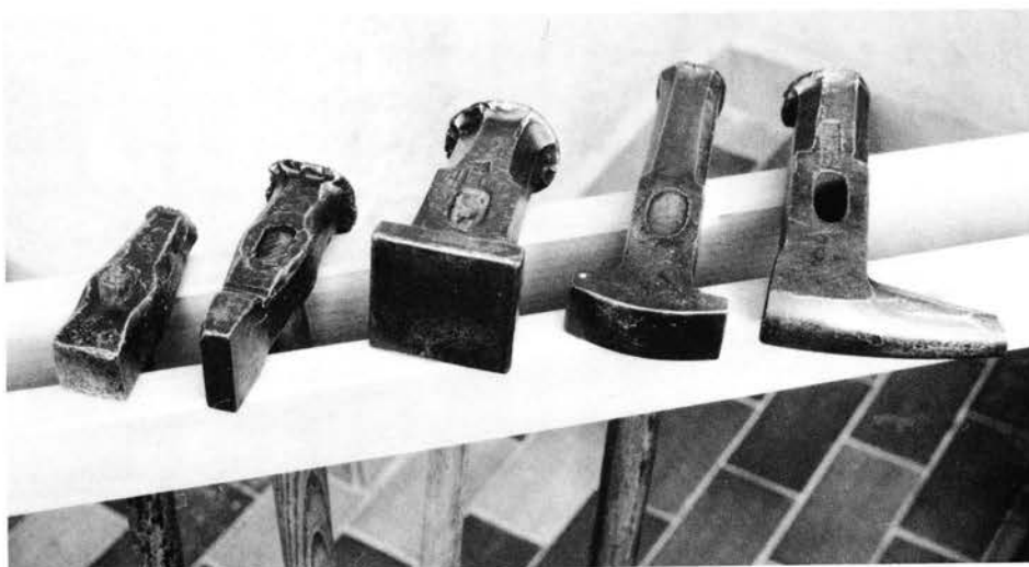
Pl. 7 Cinq chasses. De gauche à droite: chasse carrée, rectangulaire, à parer, chasse cintrée et chasse à talon.
