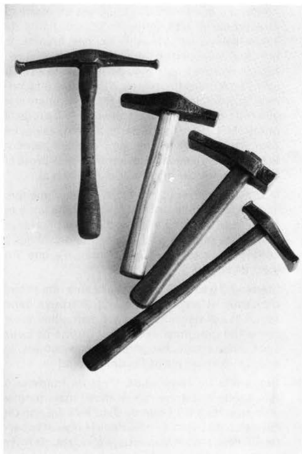
Pl. 12 A gauche: marteau à suage; à droite: trois marteaux à dégorger de chaudronnier et ferblantier, dont deux modifiés.
