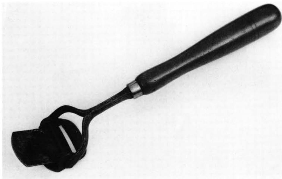
Un jeu de va-et-vient avec réglage progressif du couteau devait permettre de rogner les tranches des livres de façon artisanale et quasi manuelle, avant l'introduction des massicots ou des couteaux à excentriques.
