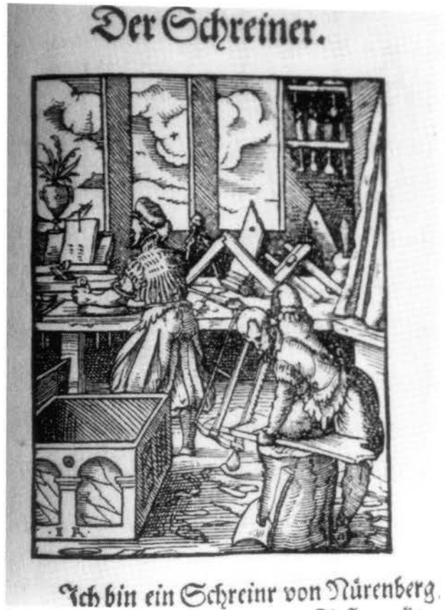
L'atelier du menuisier tel que l'a vu et représenté Jost Ammann, en 1556; on y trouve compas, équerre, équerre à onglets et trusquin à double tige.
